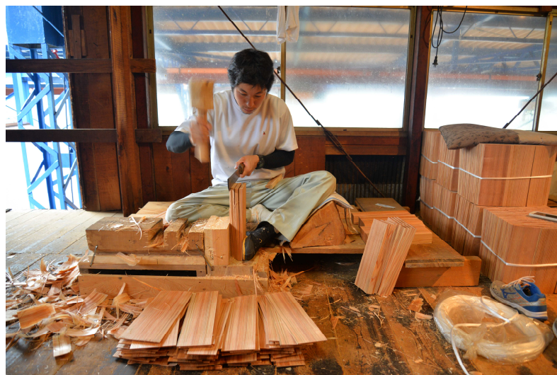
屋根板製作の様子
