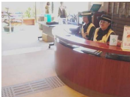
※点字ブロックには線パターンで進む方向を示す誘導ブロックと、駅のプラットフォームの端などに見かけるような点による警告ブロックがあります。点字ブロックの形状については 2001 年(平成 13 年)に制定された JIS 規格(JIS T9251 2001 年 9 月 20 日制定)があります。
