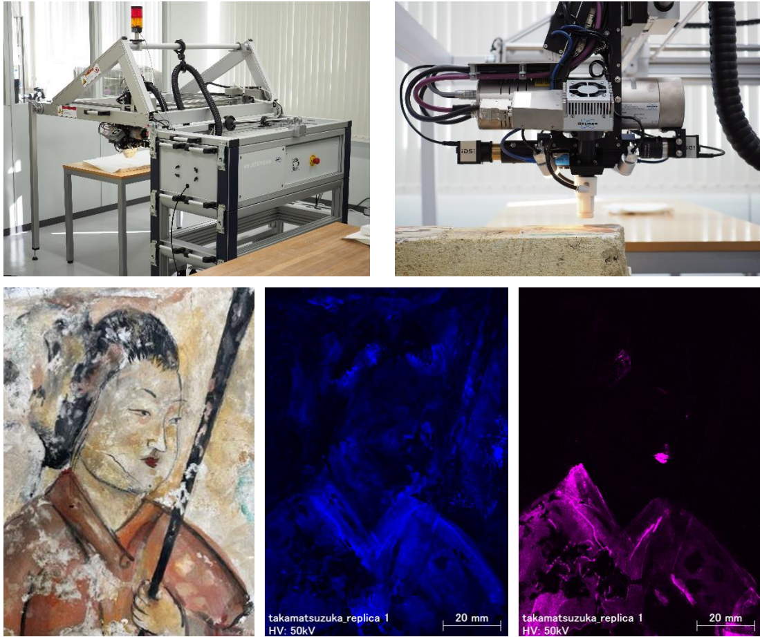
図4 上段（左）：装置全体、（右）：検出器 下段（左）：壁画（模写）、（中）：鉄の分布、（右）：水銀の分布
