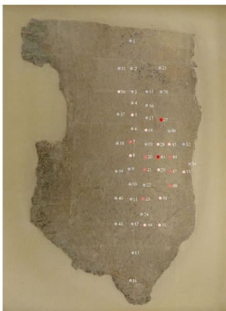
図 13 可搬型蛍光 X 線分析装置で検出された Hg の信号強度の分布
