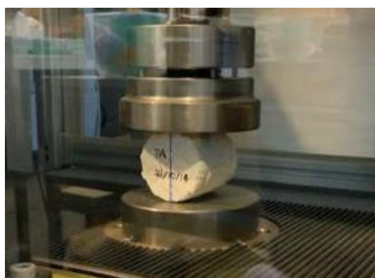
図 2 実験用漆喰の引張強度測定 (割裂試験)
