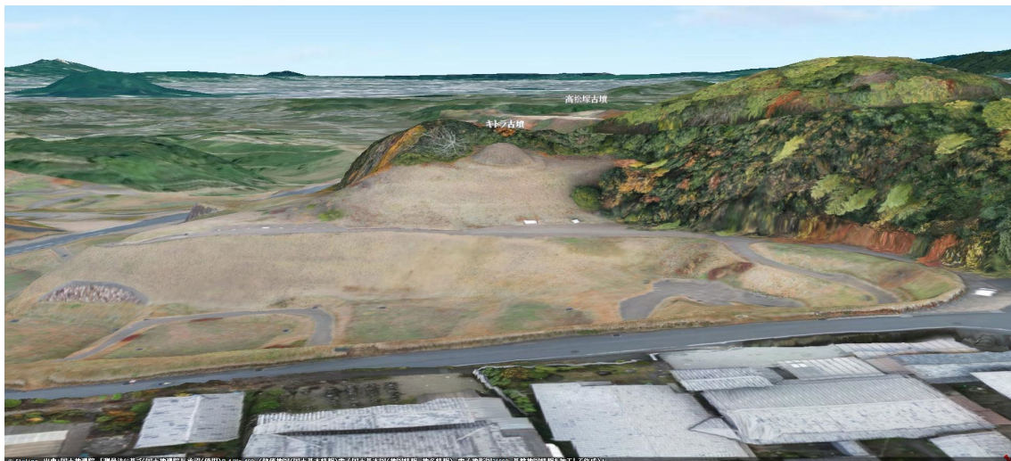
図6 UAV レーザー計測で作成したキトラ古墳と周辺地形モデル（南から）
