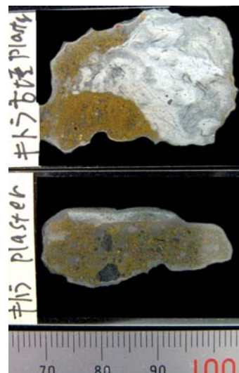
図 6. 参考資料（キトラ古墳出土漆喰の薄片（平面と垂直断面））
