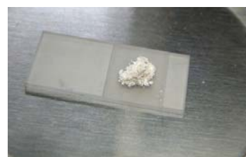
図 6. X 線回折粉末法による測定には、汚染物を取り除いた不溶残渣を分離要となる。
