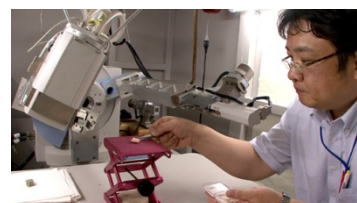
図 6. 並行ビーム法 (非破壊) X 線回折装置を用いた下地漆喰の予備調査 左は X 線管、右は検出器、それぞれ θ 角を作動させる
