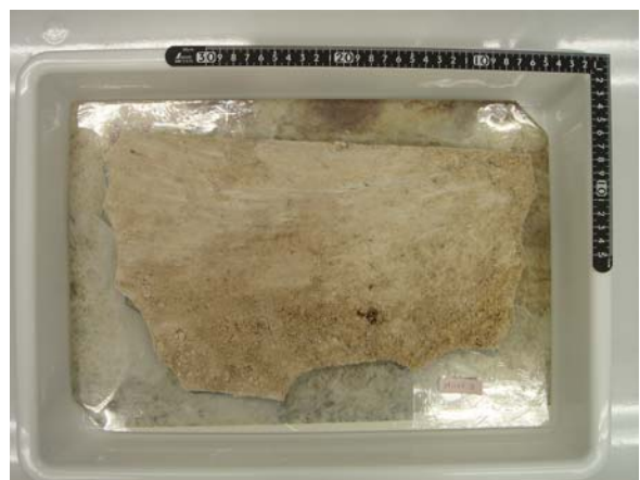
取り外した漆喰片(天井)
