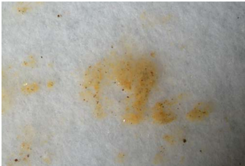
図 8. キトラ古墳石室内床面 (K7724-1)に発生した“ベージュ色ゲル”の実体顕微鏡観察像.
