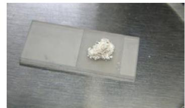
図8. X線回折粉末法による測定には、汚染物を取り除いた試料0.02gr必要となる。
