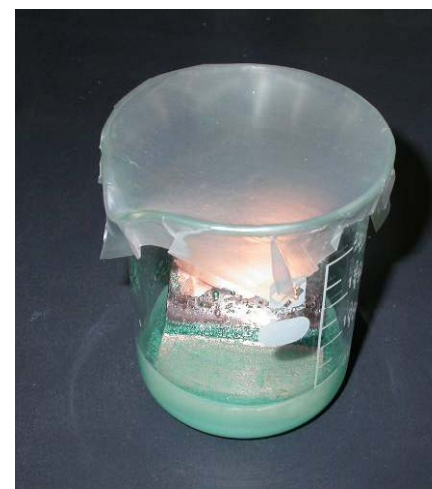
銅板を塩水に浸して製造
