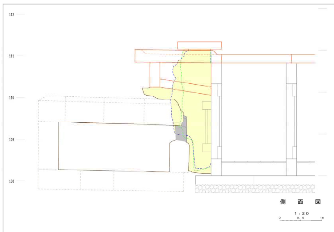
石室解体に伴う発掘調査の際に行った3D測量による側面図
