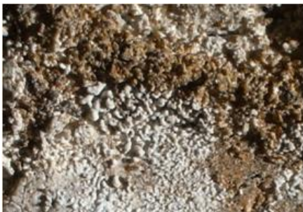
写真 15 漆喰が空隙化している場所では、細かい粒状の乳白色物質の発生がみられた（西壁・白虎像）
