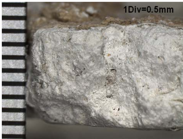
図 11a. 下地漆喰の厚さは 3.5-2.0mm で、その上に乳白色の物質、さらにその上に土が 0.5mm 前後の厚さで付着していた。
