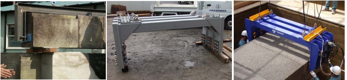
左から第一世代から第三世代型天井石吊り上げ用治具（試作から実用化へ）
