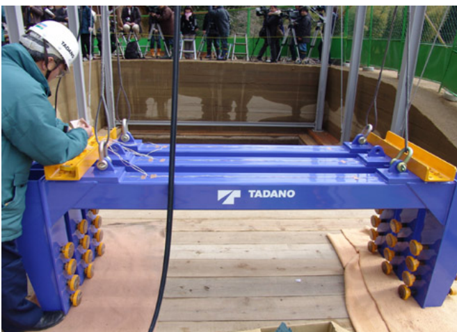
図 8.1 門型治具の上部の梁（6ヶ所）に付けられた把持力等の評価に用いられる歪センサー
