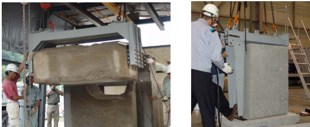
図5. 第二世代型の天井石吊り上げ用門型治具（左）と壁石吊り上げ用L型治具（右） 第一実験場等で実験がおこなわれた。
