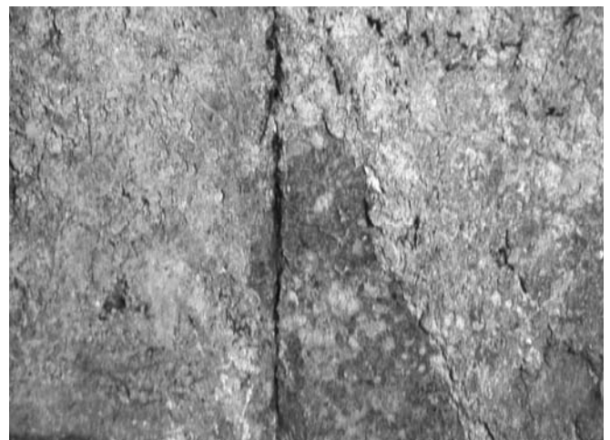
図 1.12 樹脂光沢が残存している（図 1.11 拡大）。
