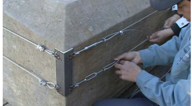
図 6. 実験ではステンレスワイヤーを引っ張るのにターンバックルを使用したけど、改善する
