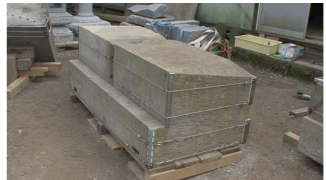
図 7. 中央に大きく断裂する実験用天井石を拘束した完成時のイメージ
