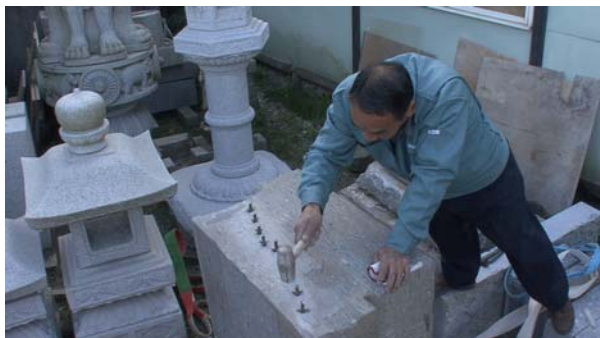
図 7. 実物と同様な亀裂を入れる
