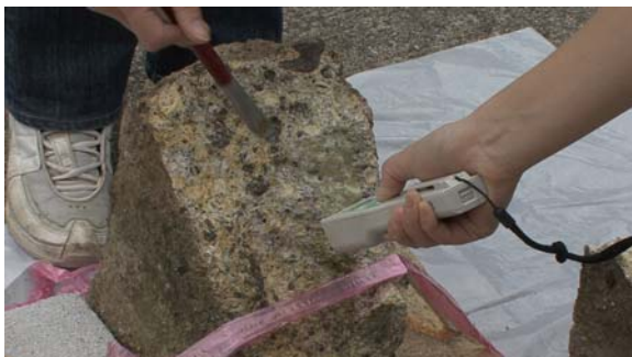
図 21. 高松塚古墳と同質の凝灰岩で実験
