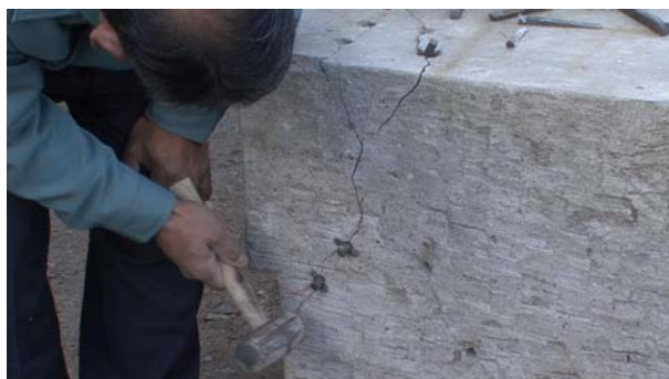
図 13. 実物と同様な亀裂を作る
