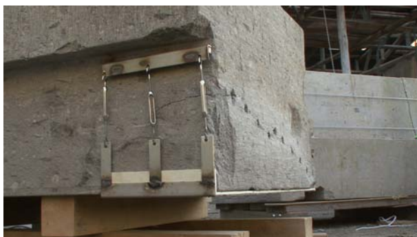
図 11. 同様に反対側も接続して、締め付ける
