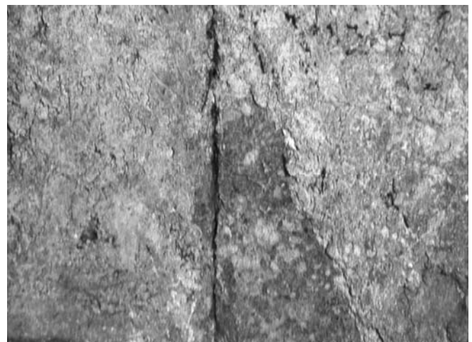
図 1.12 樹脂光沢が残存している（図 1.11 拡大）。
