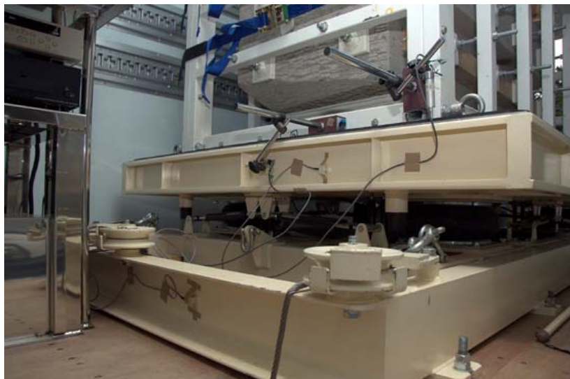
図4 取り付けられた変位計と加速度計
