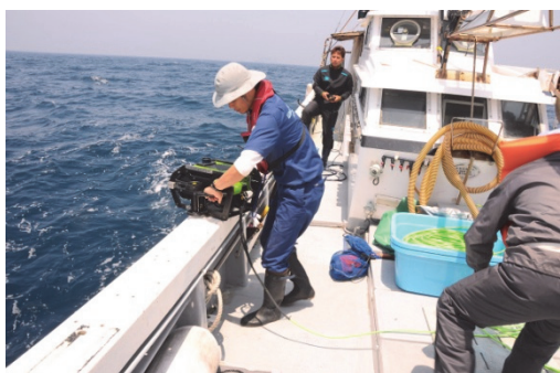
水中ロボットの投入状況
