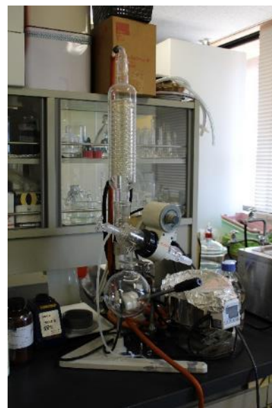
ロータリーエバポレーター
