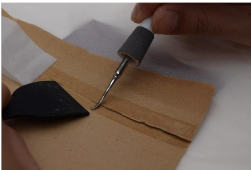
図 64. テープ除去（加温による除去）
