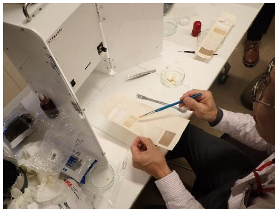
図 91. 簡易ドラフト装置を用いて有機溶媒（THF）をタルクを混ぜてシップするように用いてテープ痕を除去
