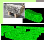
石材の3次元化とPC上での積み上げ検討
