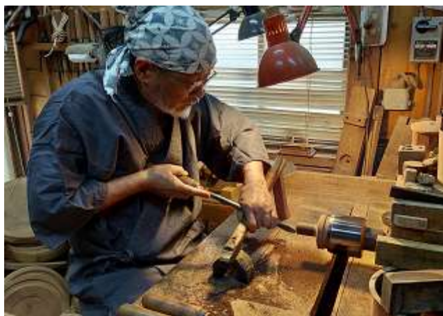
(轆轤により削り加工を行う様子)
