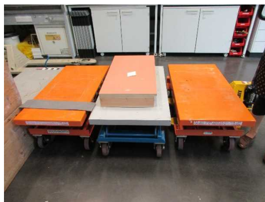
重量物を移動させるのに使用する 昇降する台車
