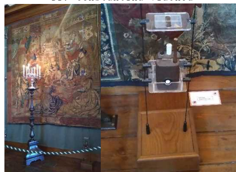
褪色を計測するモニター。 距離を置くと気にならずに タペストリーを鑑賞できる。
