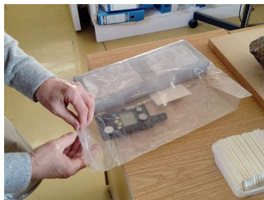
調湿のために展示ケースに入れているアートソープ 調湿性能を確認する実験
