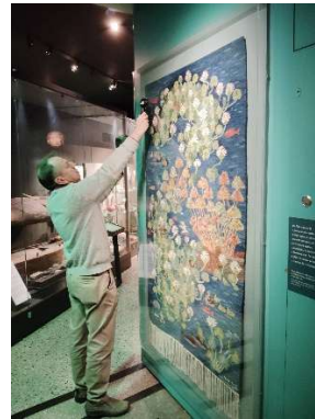
照度計で染織品コレクションの展示ライトの照度計測
