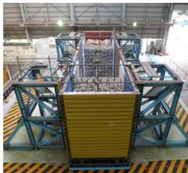
実大石垣模型の振動台実験
