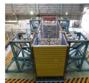
実大石垣模型の振動台実験
