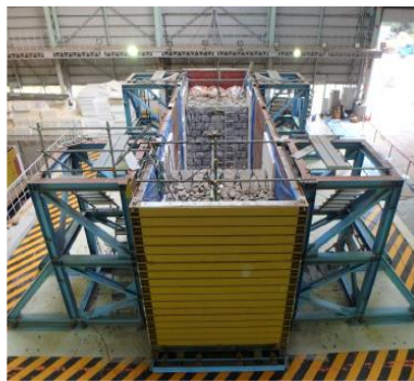
実大石垣模型の振動台実験
