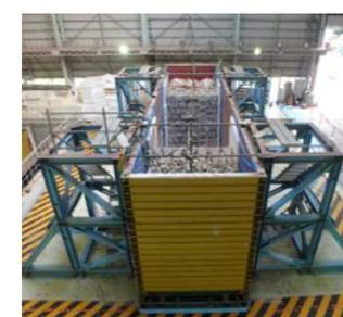
実大石垣模型の振動台実験
