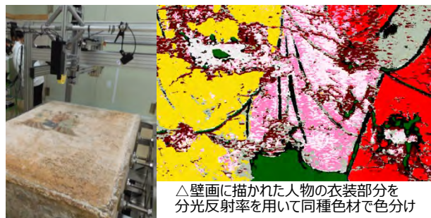
ハイパースペクトルカメラによる色材分析の様子と結果（部分）
