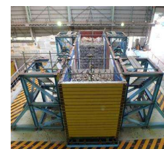
実大石垣模型の 振動台実験
