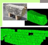
石材の3次元化とPC上での積み上げ検討
