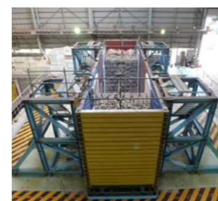
実大石垣模型の 振動台実験
