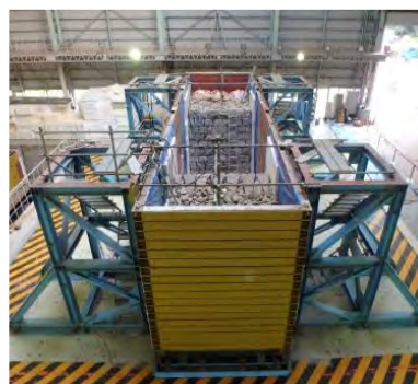
実大石垣模型の振動台実験
