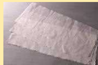
薄く柔らかい美洒紙の完成 薄い、柔らかい、丈夫であることから表具の中裏紙、増裏紙に用いられる。
