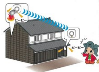
周囲に火災発生を知らせよう建物外に住警器を設置
