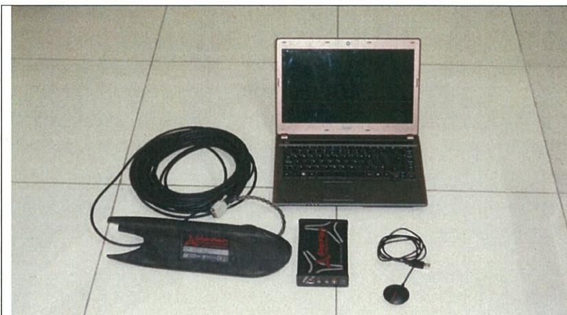
\* 機材事例 : Tritech Side Scan Sonar-Starfish 450F and cables。周波数 450kHz、最大 100m の範囲をカバー。
