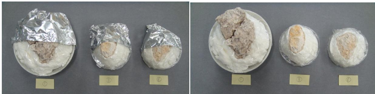
実験に用いた漆喰片の上半分をアルミ箔で覆い、紫外線の当たらない箇所を作り、紫外線照射を行った。
