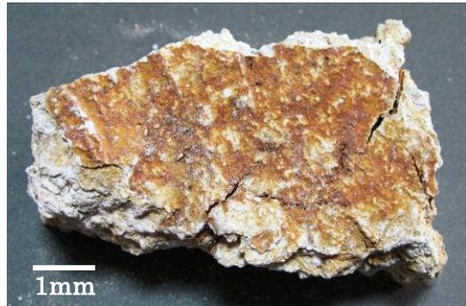
図 1 目地漆喰試料のマクロ像
