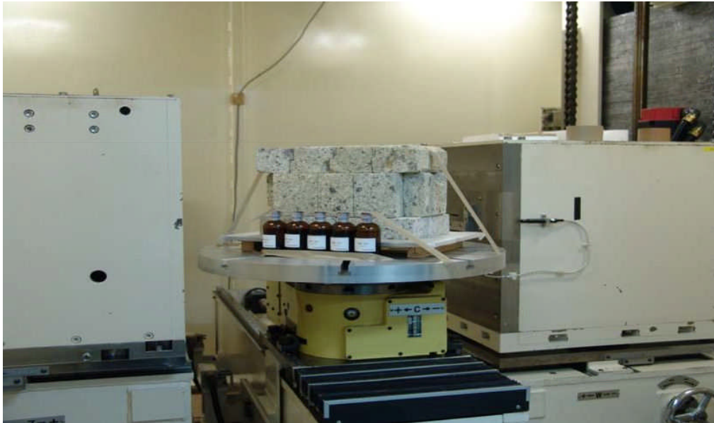
高エネルギーX線 CT を用いた 1/10 石室模型（凝灰角礫岩）の密度分布測定
