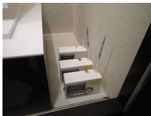
キトラ古墳壁画保存管理施設 空気環境の管理と検知管法による調査風景
