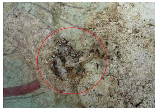
漆喰の粗鬆化により陥没した例 (西壁女子群像) (左) および充填箇所 (右)
