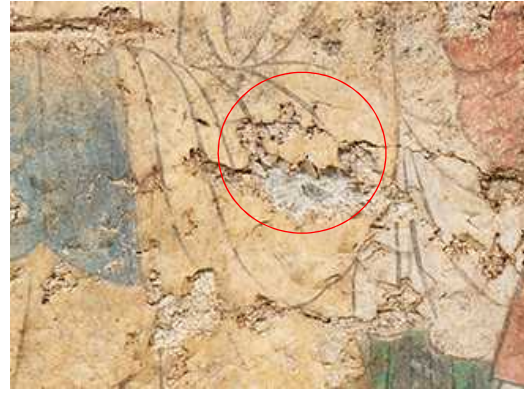
粗鬆化した漆喰により最表層が動いた例 (西壁女子群像) (左:平成 25 年、右:平成 30 年)
