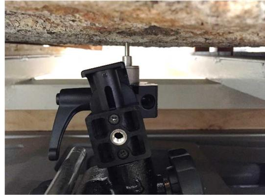
図5 変位計（石材鉛直方向の変位、石材下端部上向きに設置）
