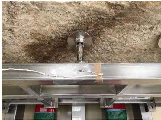
図6 ひずみゲージ（天井石4）
