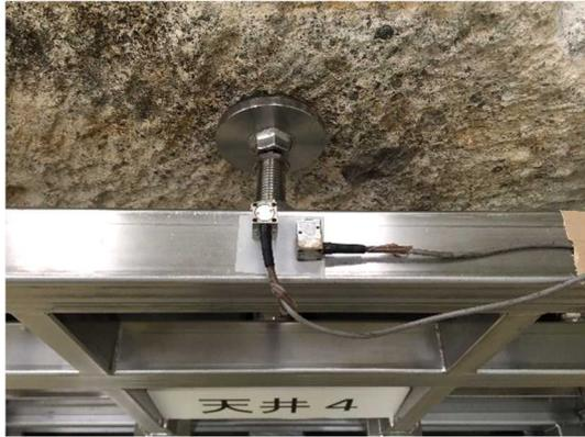
図4 加速度センサー（進行方向左右方向と鉛直方向）
