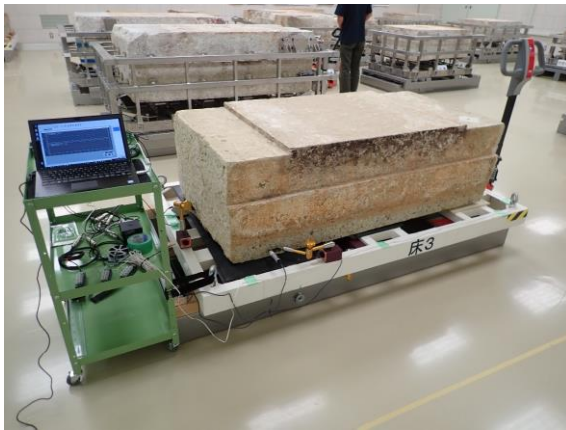
図3 石材輸送実験風景（床石3）
