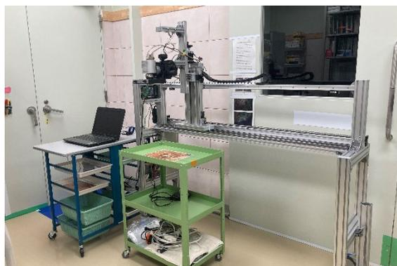
図4 壁画撮影用の治具に取り付けた状態（対象物との距離は実際の測定と同じ）
