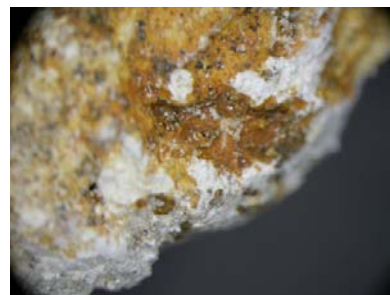
図 4. 漆喰表面は淡黄褐色のゼリー状物質で覆われている。
