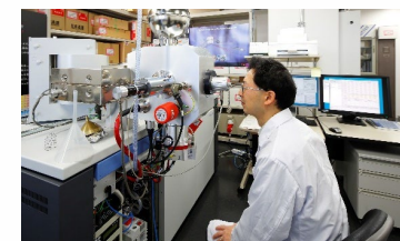
質量分析計による隕石の同位体分析
