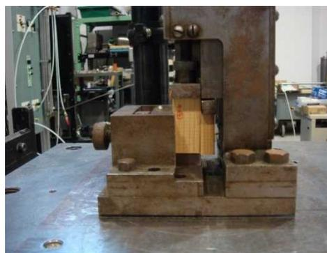
写真 5. 4 : せん断試験状況
