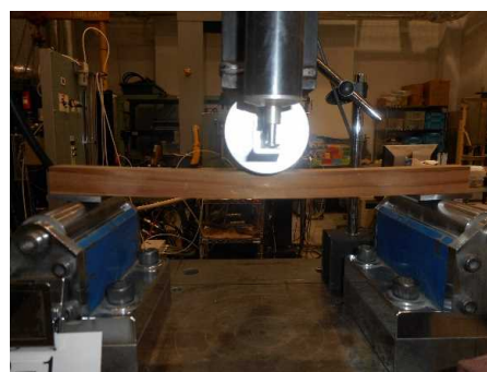
写真3. 2：曲げ試験状況
